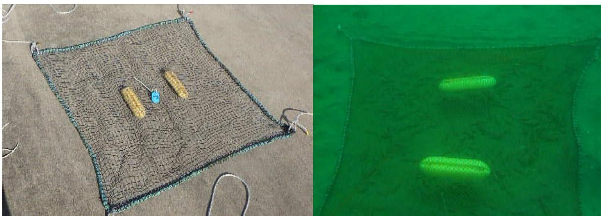
写真1 設置した被覆網の構造と水中での網なり
