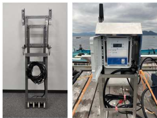
図 4 ソナーの設置状況（生簀網角の外側に設置し 3 台のソナーから表層・中層・底層に音波を照射）
