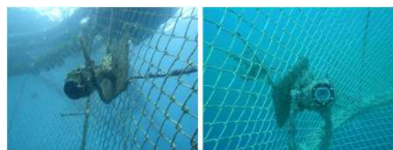
図 3 水中カメラ（計 4 台）の設置状況（設置場所：生簀角の水深 1 m 層と水深 7 m 層に各 1 台、底網から真上に向けて 1 台、海面の天井網に 1 台）
