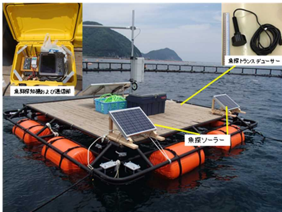
図2 観測筏及びテレメーター式魚群探知機
