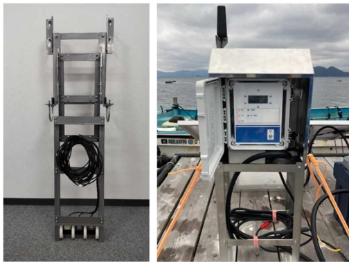
図4 ソナーの設置状況（3つのソナーを生簀の表層・中層・底層の3方向に設置）
