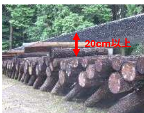
空間を設けて遮光ネット設置
