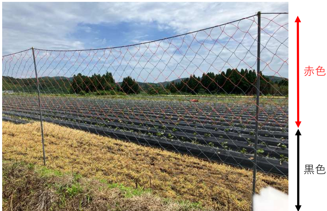
検証しているネットタイプ電気柵 (網が赤くなっている箇所が通電部)
