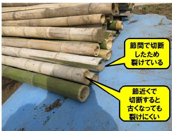
写真 1 1 切断位置による支柱強度の違い 図 4 積雪の偏りによるハウスの倒壊
