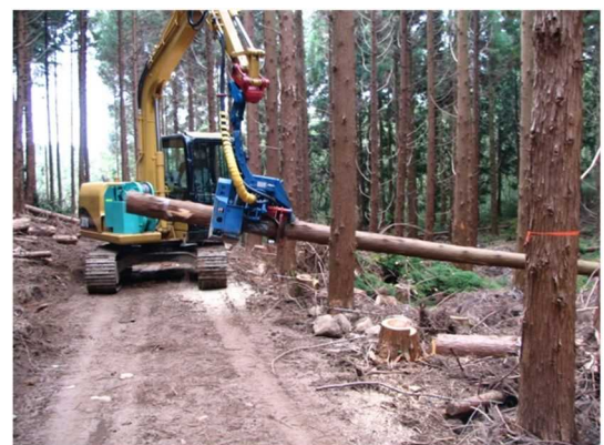
高性能林業機械による搬出間伐
