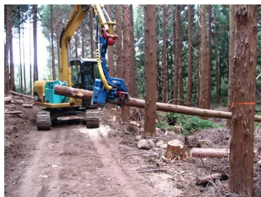
高性能林業機械による搬出間伐
