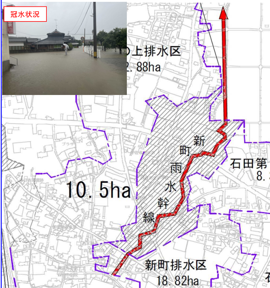
新町排水区における雨水幹線整備
