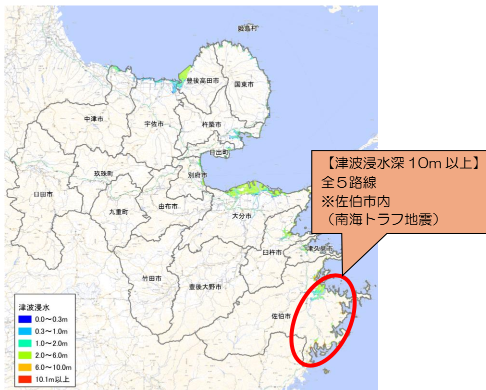
図 6-4 大規模津波による被害想定区間
