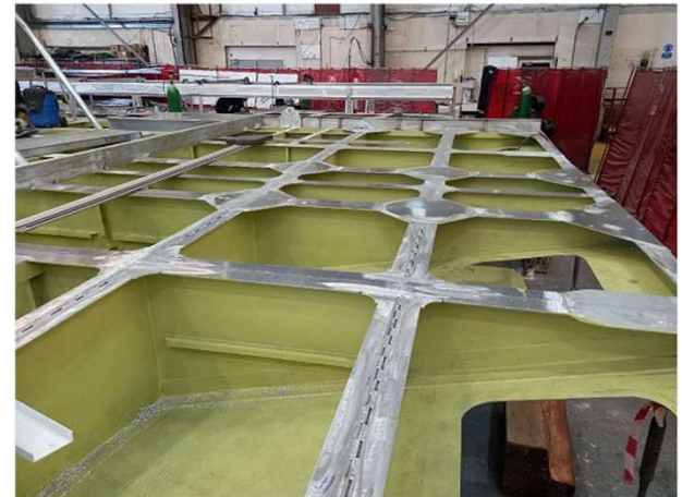
船体後部内部構造
