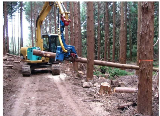
高性能林業機械による搬出間伐
