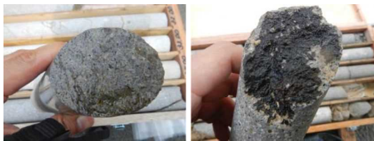
Figure 4 (左)褐鉄鉱付着のない新鮮な転石表面 (右)褐鉄鉱汚染の著しい転石表面
