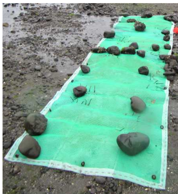
図1 干潟に設置した二重網
