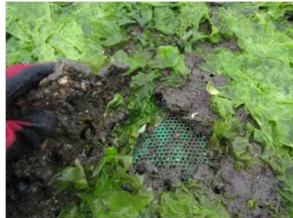
図6 アオサとホトトギスガイが大量に付着した二重網
