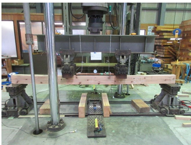
写真-1 408の曲げ試験の様子
