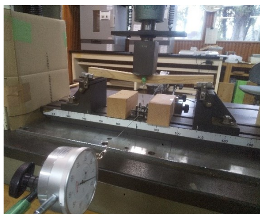
写真-1 曲げ試験の様子
