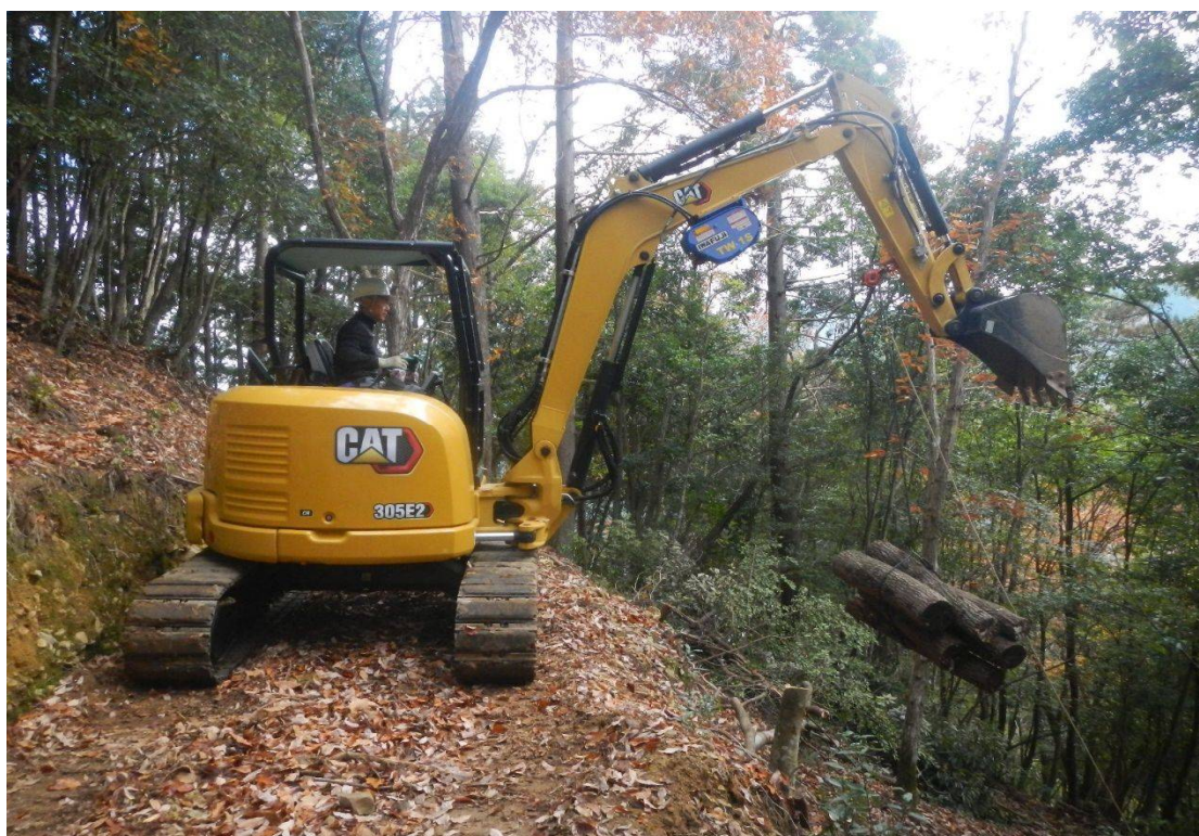
バックホウ活用による作業省力化
