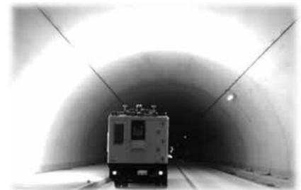
レーザーと高解像カメラを搭載した
