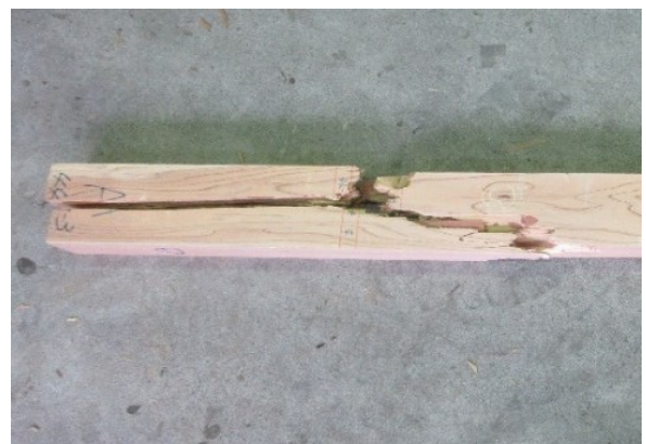
写真-2 せん断破壊の様子
