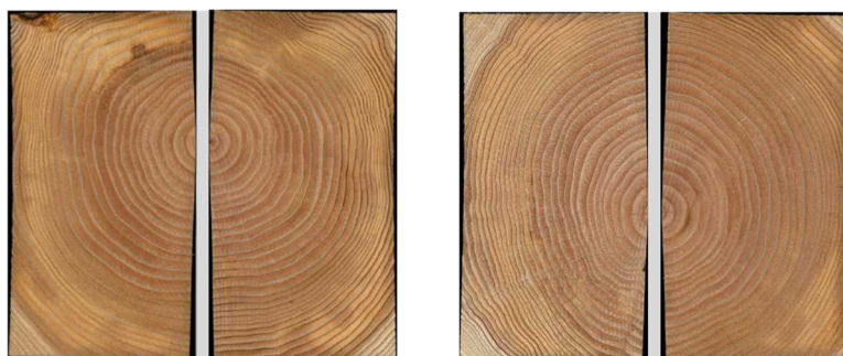
写真-3 2丁取り 20 の断面（養生後）
