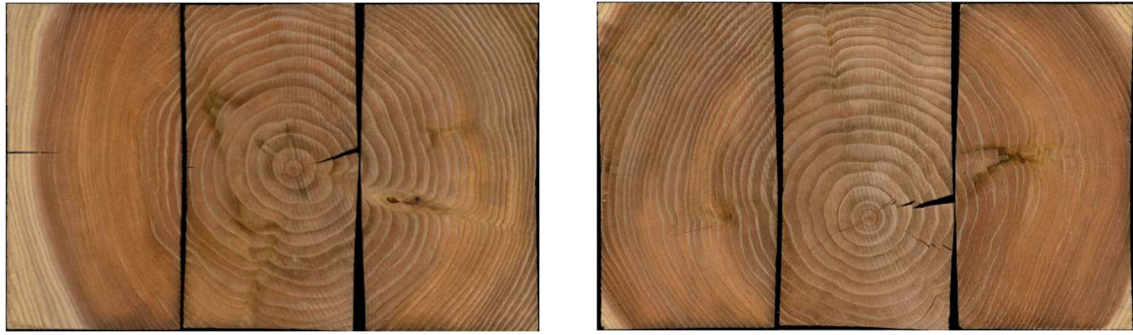
写真-5 3丁取りの断面（養生後）
