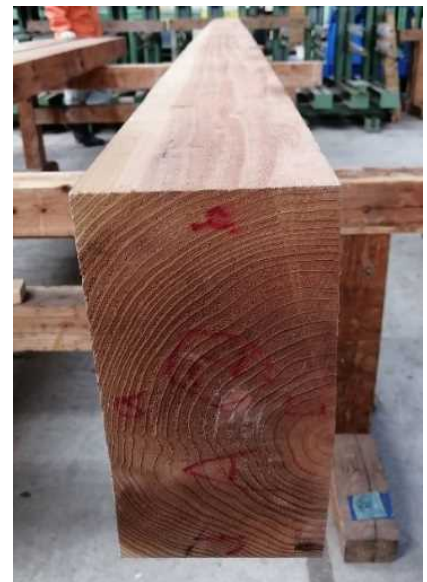
写真-6 髓が残っている 心去り材
