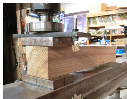
写真-1 材端部めりこみ試験
