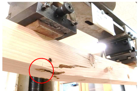
写真-4 引張側の節（丸印）からの曲げ破壊
