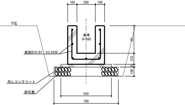
雨水排水側断面詳細図 S=1/10
