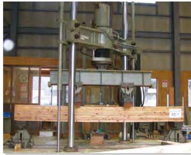
▲ 県産材を活用した建築用材の実大強度試験
