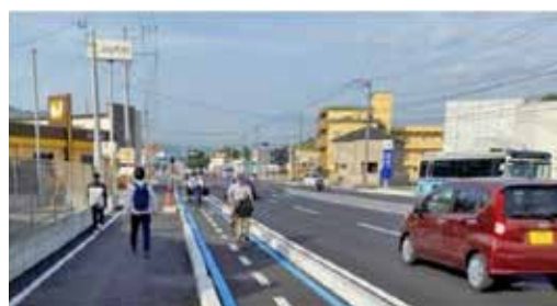
自転車の分離状況 国道442号(大分市)
