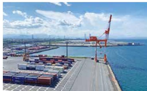
※1 港湾の岸壁に設置され、船と陸地との間でコンテナなどの積み下ろしを行う大型の荷役機械
