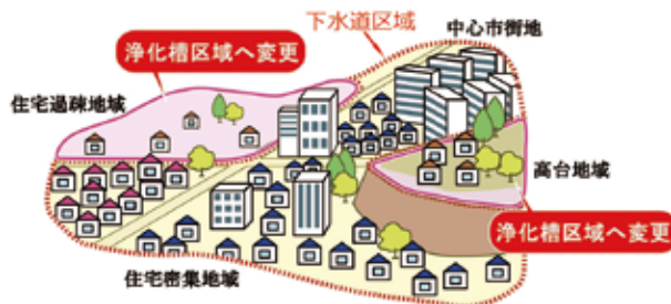
生活排水処理手法の見直し概念図 (下水道区域を浄化槽区域に見直した例)
