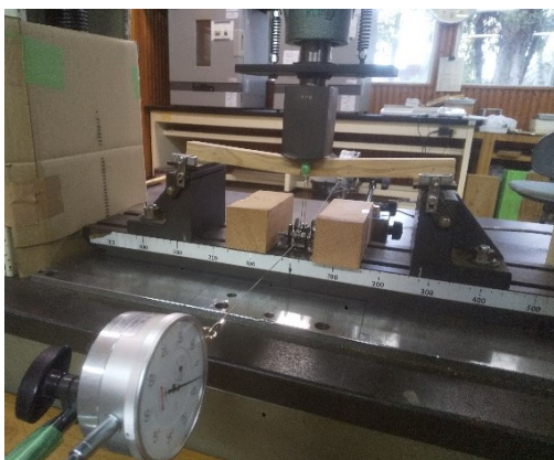
写真-1 曲げ試験の様子
