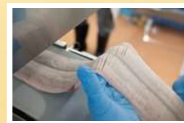
骨切り機を通したハモ。小骨もスツキリと切られています
