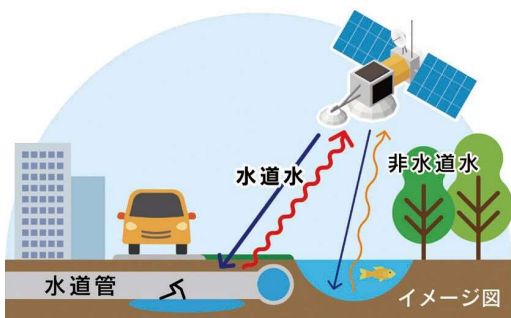
人工衛星の画像を活用した漏水判定 (イメージ図)
