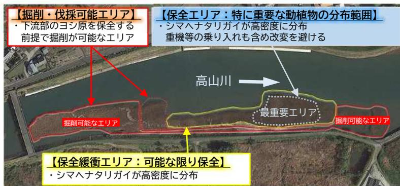
貝類分布状況に基づく掘削エリアの設定
