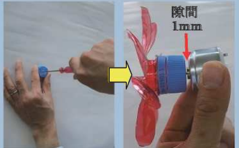
【図7】穴を開ける 【図8】軸を差し込む
