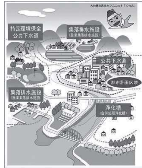
生活排水処理施設の整備手法選定の概念図
