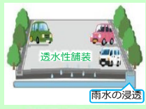
駐車場の透水性舗装による雨水の浸透
