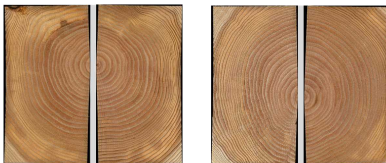
写真-3 2丁取り 20 の断面 (養生後)
