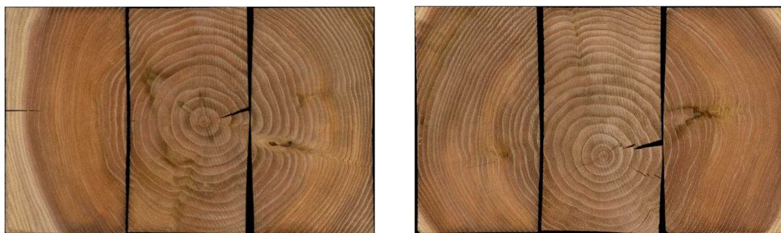
写真-5 3丁取りの断面（養生後）
