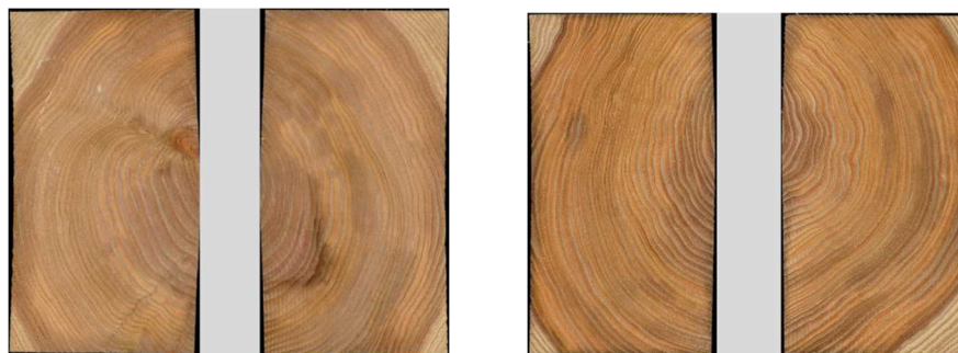
写真-4 2丁取り 50 の断面 (養生後)
