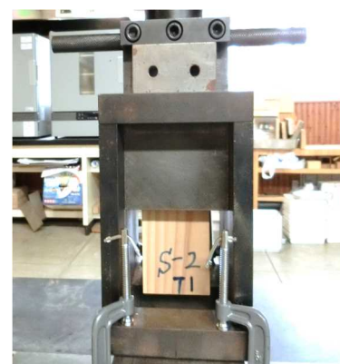
写真-3 いす型せん断試験
