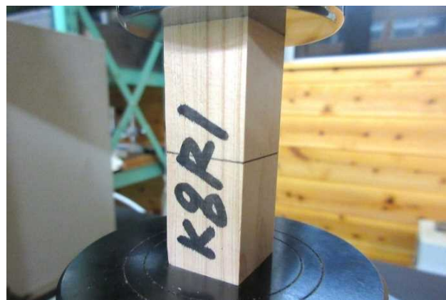
写真-2 縦圧縮試験の様子
