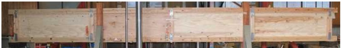
3タイプの梁の曲げ強度はいずれも基準の4倍以上あり、学校の2階床で十分使えることが確かめられました。この技術を活用すれば比較的広い空間を持つ木造建築が地元の製材所の材料で簡単に作る事が可能になります。
