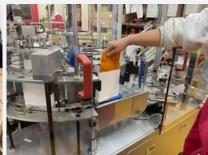
設備導入の事例(AIカメラ機能を搭載した箱折機)
