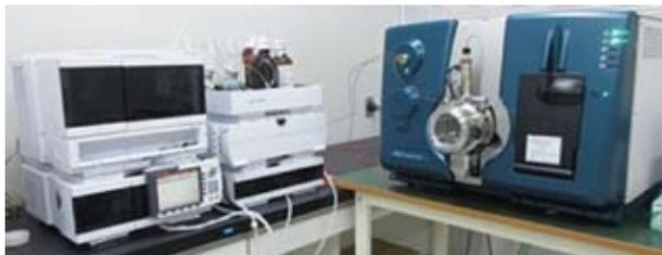
高速液体クロマトグラフ質量分析装置（LC-MS/MS）
