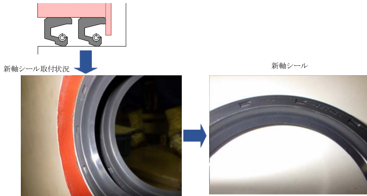
軸シール部拡大図(新軸シール)
