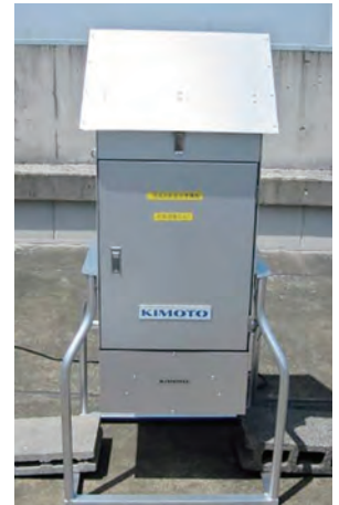
【ハイボリュームエアサンプラー】 ※空気中の浮遊じんを採取する装置
