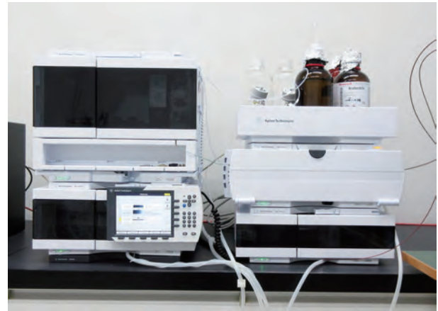
※写真は、高速液体クロマトグラフ部です。この他に質量分析装置部があります。
