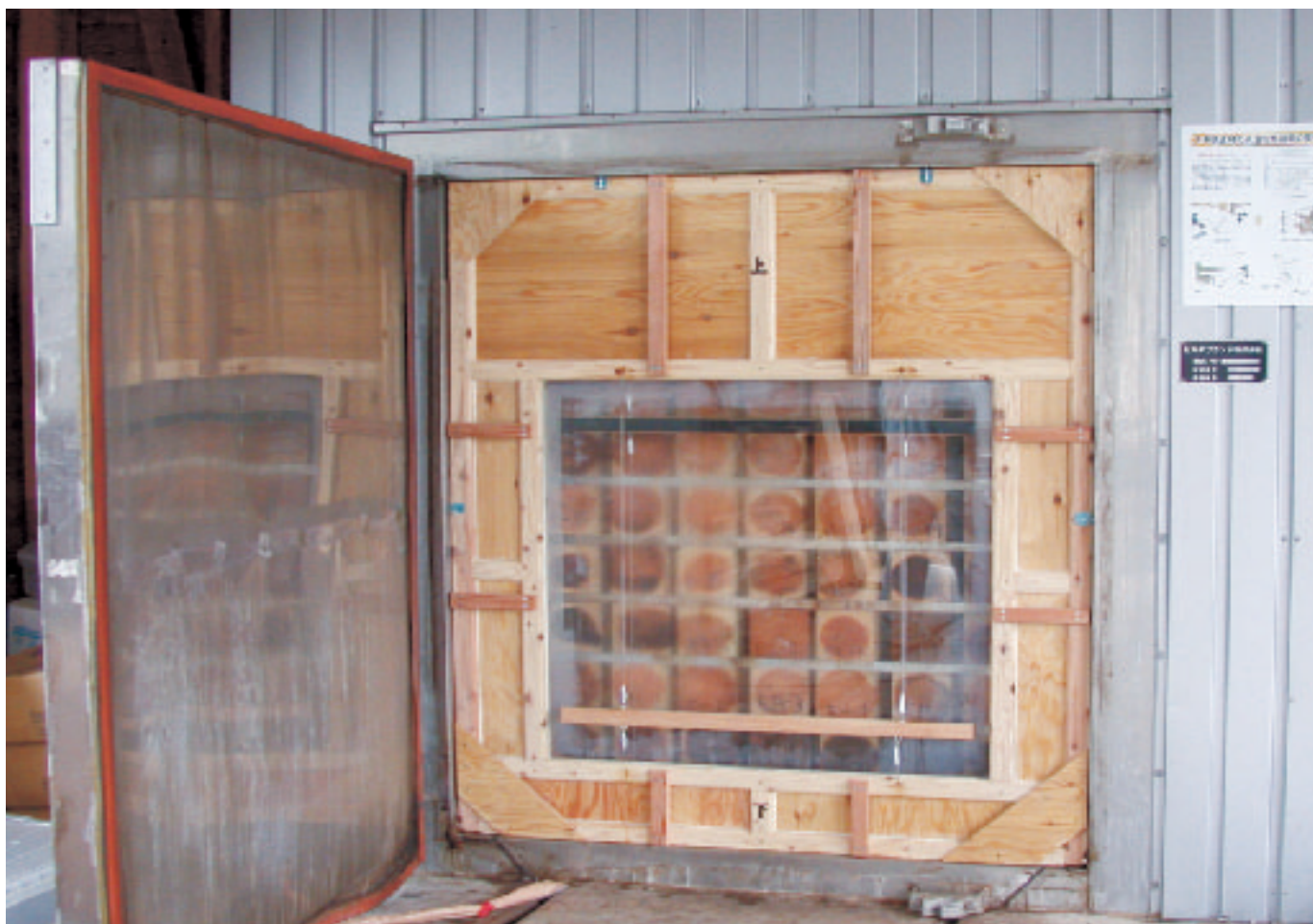
林業試験場の高温蒸気式乾燥機（新たに設置した観察窓・H17.3）
