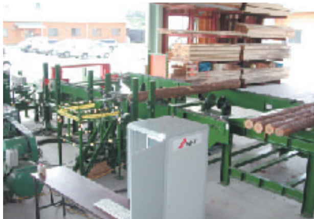
写真-1 原木の動的ヤング係数測定機
