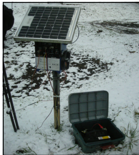
図 3．太陽パネル（左）とバッテリー（右）
