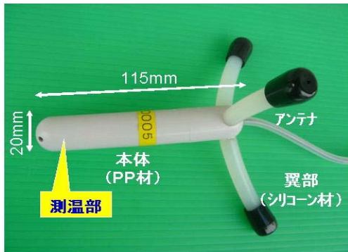
図2 耳用测温送信モジュール
