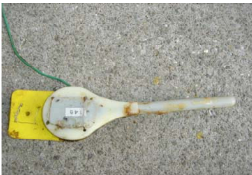
図4 臍用测温送信モジュール
