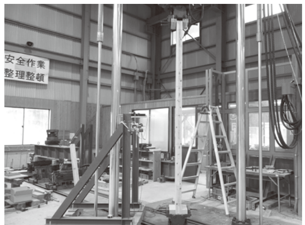
写真-5 座屈試験の様子
