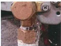
ピンポイントの漏えい検知に適している。漏えい可能性のある箇所に発泡液を塗布し、吹き出すフロンを検知。
